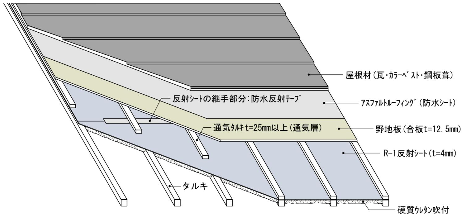
ウレタン遮熱工法 外壁廻り 施工図 外壁
